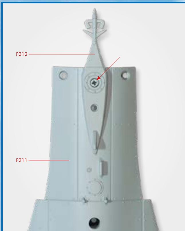
**1** На этом этапе сборки вам потребуются детали, полученные с этим номером, а также узел деталей из № 74. Соедините деталь P211 с собранной нижней частью фюзеляжа, как показано на снимке. Затем зафиксируйте детали тремя винтами КР.
